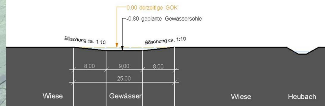
Regelprofil - Längsschnitt- M 1:500
